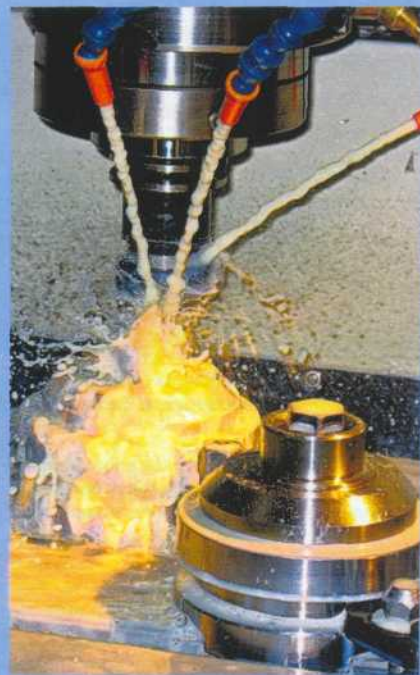
Детали обрабатывают на высокоточных станках с ЧПУ. Однако из-за неоднородности заготовок детали порой получаются «кривоватыми», отчего некоторые образцы пощелкивают при работе.
